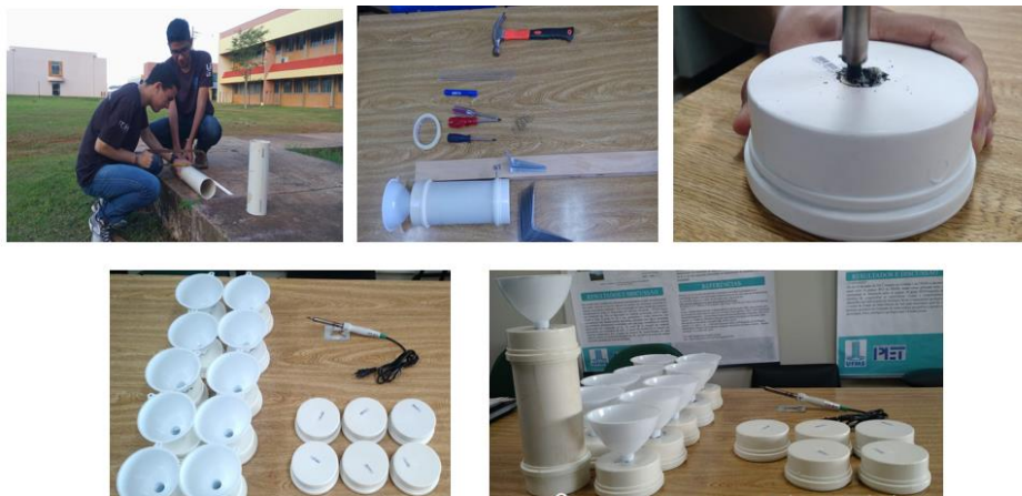
Figura 02 – Instalação da rede pluviômetros de PVC do PETGeografia
